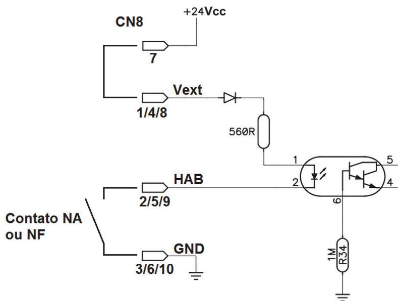
O acionamento através de pulso de tensão é a ilustrada na figura a seguir. É necessário observar a polaridade para tensões CC e usar um resistor externo para tensões altas (110 a 220 Vcc).
